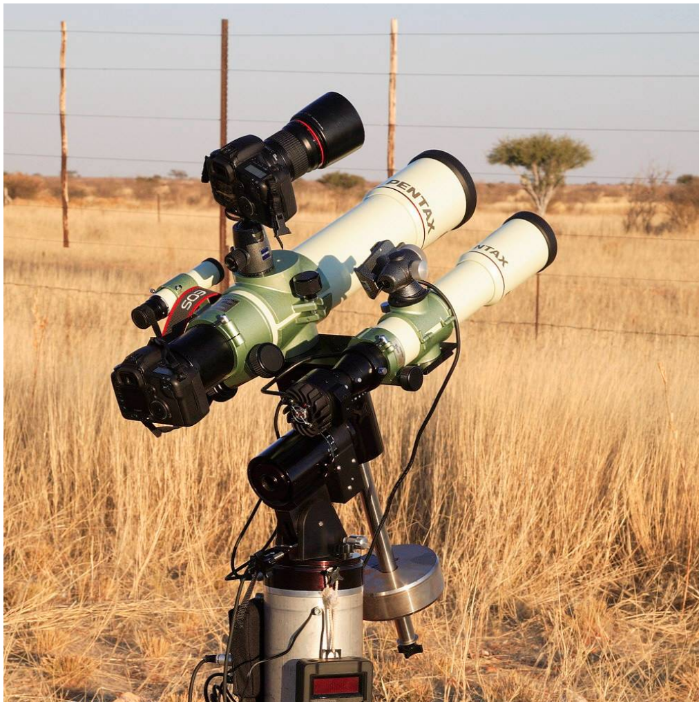
Abb. 1: Die mobile Astrofoto-Ausrüstung bestand aus einer Montierung, zwei Refraktoren mit 75mm und 105mm Öffnung, zwei Canon 20Da-Gehäusen sowie zahlreichen Tele- und Weitwinkelobjektiven. [Manuel Jung und Thomas Hugentobler]
