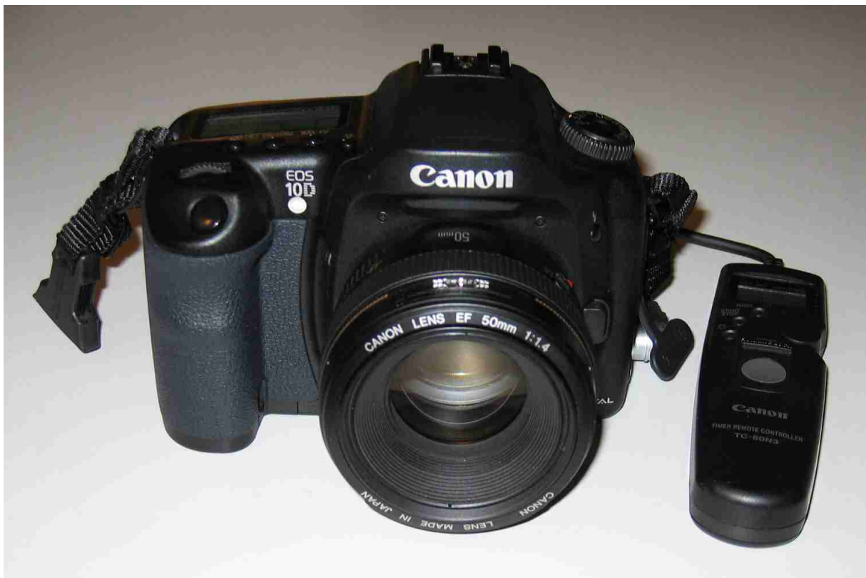
Abb. 1: Die Canon EOS 10D mit Timer-Auslösekabel TC-80N3
